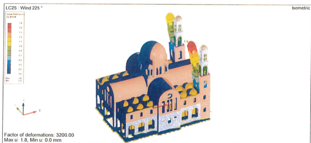
Εικόνα 44. Μετακινήσεις Ναού για τα φορτία ανέμου στη διεύθυνση 225 μοίρες.
