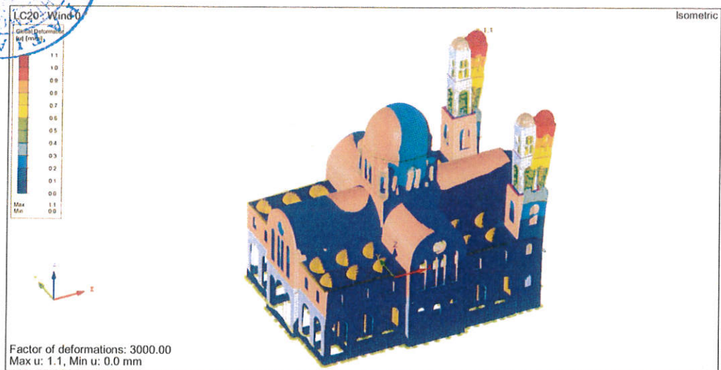
Εικόνα 43. Μετακινήσεις Ναού για τα φορτία ανέμου στη διεύθυνση 0 μοίρες.
